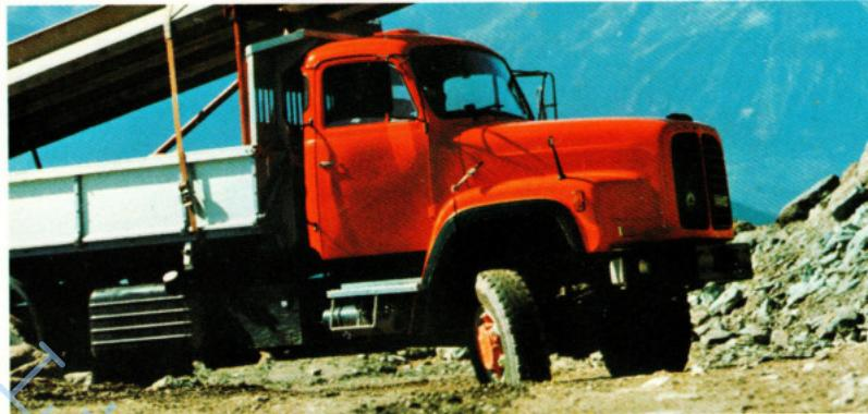
Die nach konsequentes System-Konzept gebauten Normallenker-Kabinen mit einteiliger Kunststoffhaube sind modern, sicher und von wuchtigem Aussehen. Weitere Vorteile: müheloses Kippen der Hauben-Kotflügel-Einheit. Eine Rückfallsperre sichert die aufgestellte Haube. Leichte, allseitige Zugänglichkeit zum Motor und zu allen Aggregaten für Kontroll- und Wartungsarbeiten. Serienmässige Hohlraumbehandlung mit 5-Jahres-Rostschutz-Garantie.
