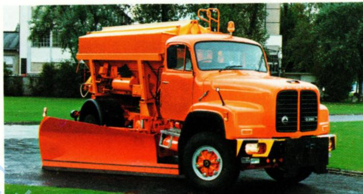
Die nach konsequentem System-Konzept gebauten Normallenker-Kabinen mit einteiliger Kunststoffhaube sind modern, sicher und von wuchtigem Aussehen. Weitere Vorteile: müheloses Kippen der Hauben-Kotflügel-Einheit. Eine Rückfallsperre sichert die aufgestellte Haube. Leichte, allseitige Zugänglichkeit zum Motor und zu allen Aggregaten für Kontroll- und Wartungsarbeiten. Serienmässige Hohlraumbehandlung mit 5-Jahres-Rostschutz-Garantie.
