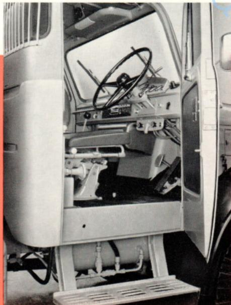
Der bequeme Kabineneinstieg erleichtert die Arbeit des Fahrers. Beachtenswert ist die günstige Anordnung von Sitz, Pedalen, Lenkung und Bordinstrumenten, sowie die nach allen Seiten ungehinderte Sicht auf die Strasse.
