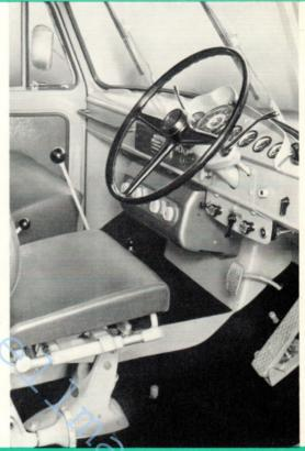
Die geräumige Kabine ist für drei Personen gebaut. Ein in allen Teilen einstellberer Führersitz mit Federung und Stossdämpfer bietet den besten Fahrkomfort. Die günstige Anordnung von Pedalen, Lenkung und Bordinstrumenten, sowie die nach allen Seiten unbehinderte Sicht auf die Strasse erleichtert die Arbeit des Fahrers.
