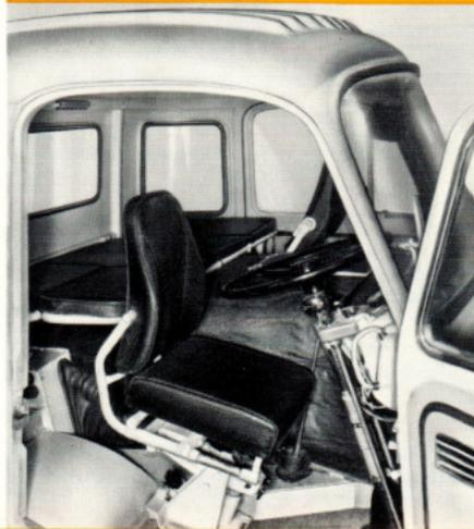
Zwei einstellbare Sitze sind beidseitig der mit einer Decke gut isolierten Motorhaube angeordnet. Bei vorgeklappten Sitzen steht eine breite Schlafbank zur Verfügung.
